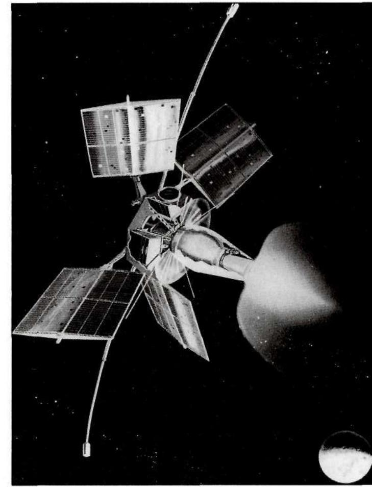
El satélite Explorer 33, con paneles extendidos con los que se alimenta de energía solar, está diseñado para estudiar los fenómenos interplanetarios desde la órbita lunar. En ella puede funcionar sin que le afecten las influencias del campo magnético de la Tierra, cuya potencia es cuarenta veces superior al de la Luna, pero este campo magnético cambia de polaridad cada 10.000 años, permitiendo el libre acceso de las radiaciones cósmicas que pueden causar graves daños a los seres vivos.
